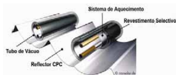
Figura 6.20 - Estrutura esquemática de um colector CPC
