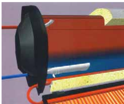
Figura 3.25 – Pormenor de isolamento de depósito solar
