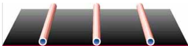
Absoror com um sistema de tubos soldados numa chapa de metal Fonte: Wagner
