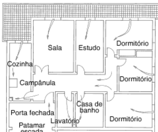
Fig. 3. Esquema de Sistema de Extracção
