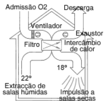
Fig. 7. Igual às Figs. 4 e 5, incluída a instalação de um permutador de calor
