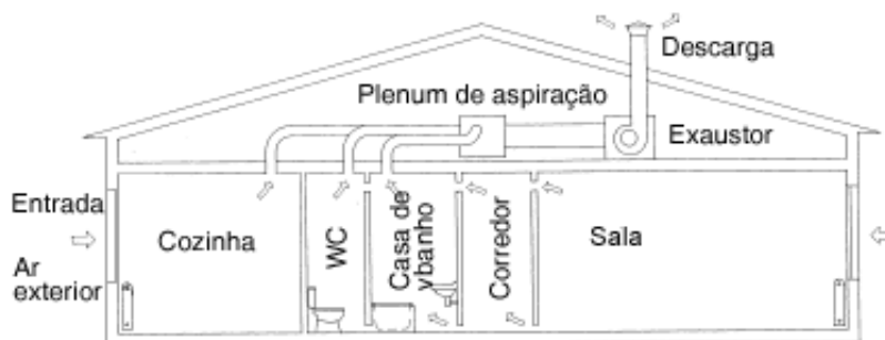
Fig. 1. Esquema de Sistema de Extracção Centralizada
