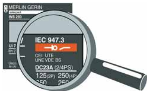
Marcado de un interruptor apto al seccionamiento.
