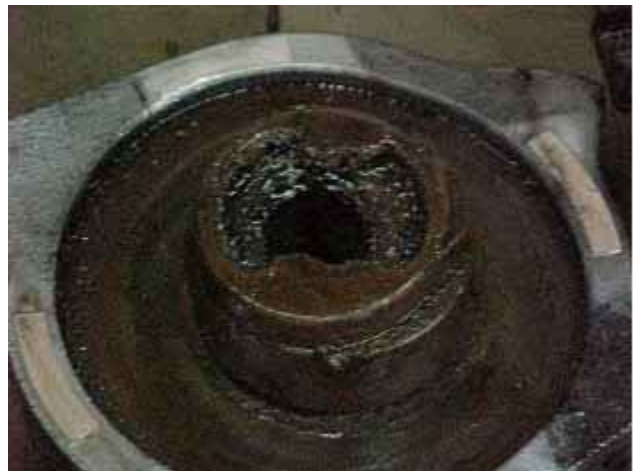
Degradação do óleo umidade excessiva
