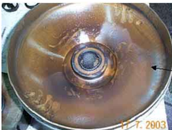
Desgaste provocado por lubrificação deficiente
