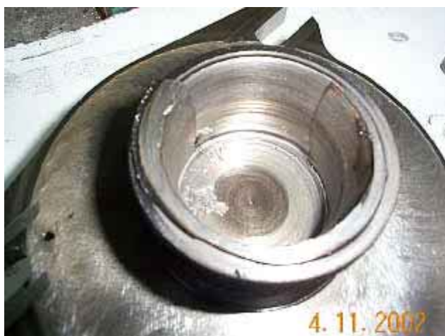
Desgaste excessivo provocado por lubrificação deficiente
