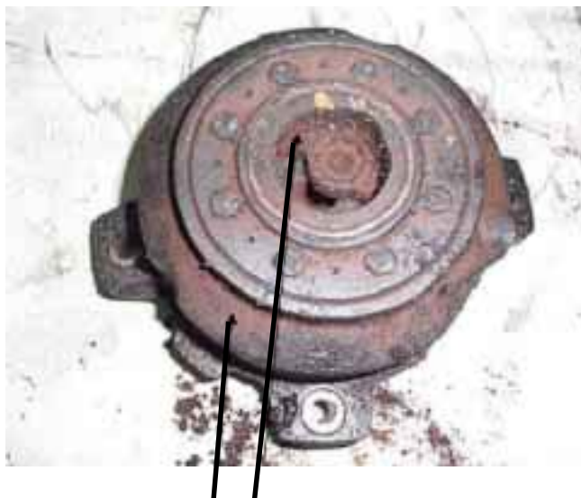
Parte superior do Scroll com muita sujeira e umidade
