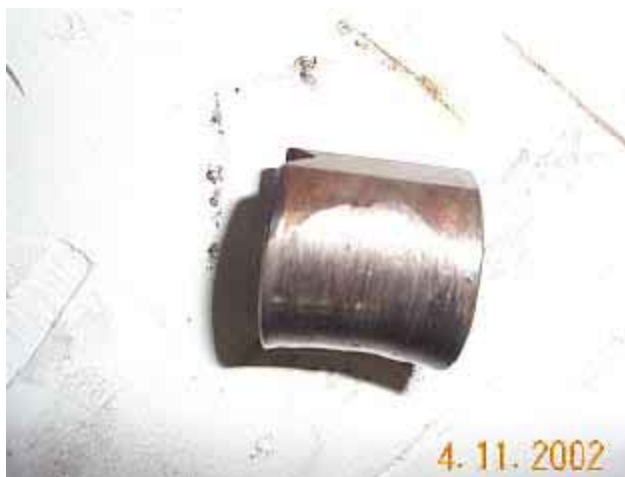
Remoção do lubrificante por refrigerante "Wash Out"
