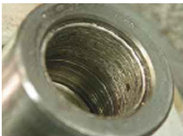
Remoção do lubrificante por refrigerante
