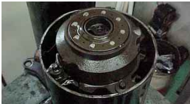
Falta de lubrificação
