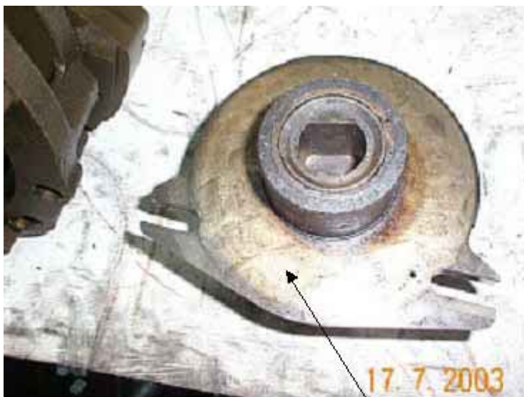
Desgaste provocado por lubrificação deficiente
