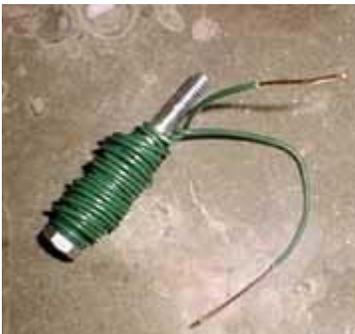
Enrolamos as duas extremidades livres juntas. Usando um desencapador de fios, removemos cerca de 2 cm de isolamento de cada extremidade do fio. É possível usar uma faca no lugar do descascador de fio.
