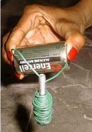
Para usar o eletroímã, seguramos as extremidades da bobina do fio contra a bateria e levantamos alguns cliques de papel. Esse eletroímã levantou 21 cliques de papel. Foram os mesmos cliques de papel que utilizamos para o Desafio do Barco de Massa de Modelar.
