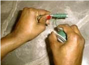
Seguramos uma extremidade do fio contra o parafuso, com alguns centímetros saindo pelas laterais. A próxima etapa foi enrolar o fio no parafuso em camadas, indo para a frente e para trás até que o comprimento de 250 cm estava quase todo utilizado, exceto por alguns centímetros.
