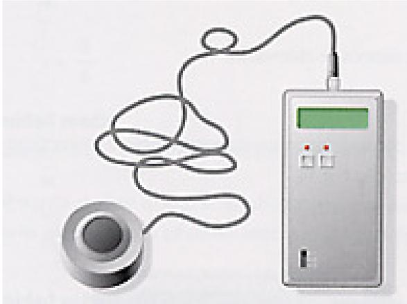
A medida do nível de iluminância realiza-se por meio de um aparelho especial chamado luxímetro, o qual consiste numa célula fotoelétrica, sobre a qual se faz incidir o fluxo luminoso, que gera uma fraca corrente eléctrica, a qual aumenta em função do fluxo incidente.
