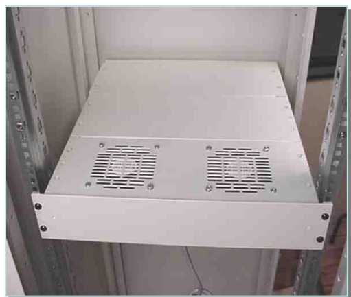
Figura 66- Bastidor de parede e sistema de ventilação
