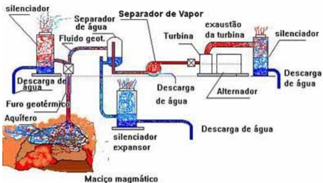
Figura 17 – Esquema de funcionamento da Central geotérmica do pico Vermelho
