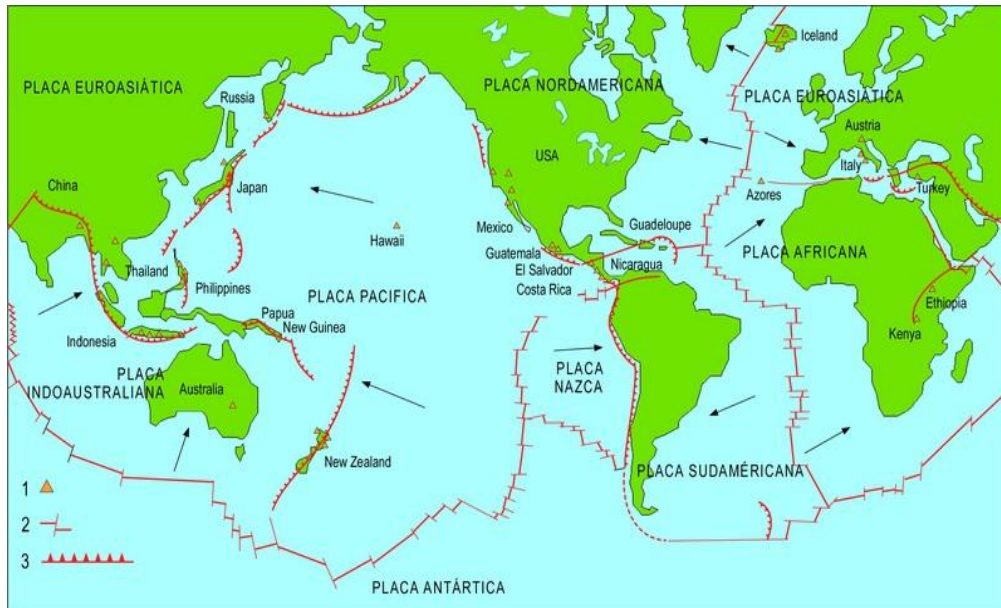
Figura 6 - Localização de Placas litosféricas, dorsais oceânicas, fossas oceânicas, zonas de subducção e campos geotérmicos. As setas indicam a direcção do movimento das placas até as zonas de subducção
