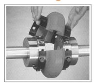
Gire o eixo a 180º e monte a outra metade do elemento Omega. Se o eixo não puder ser girado monte as duas metades lado a lado.
