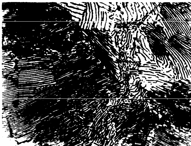
FIGURA 9.8 Microestrutura de um aço eutectóide arrefecido lentamente. Consiste em perlite eutectóide lamelar. A fase que, após o contraste, aparece mais escura é cementite e a fase branca é ferrite. (Reagente de contrastação: picral; ampliação 650 \times .) (United States Steel Corp., no "Metals Handbook", vol.8, 8.ª ed., American Society for Metals, 1973, p.188.)
