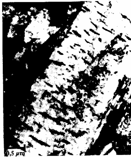
FIGURA 9.30 Precipitação de \text{Fe}_3\text{C} na martensite de um aço com Fe-0,39%C revenida durante 1h a 300°C. (Fotomicrografia obtida em microscópio electrónico.) (G. R. Speich e W. C. Leslie, Met. Trans. , 31:1043(1972).)
