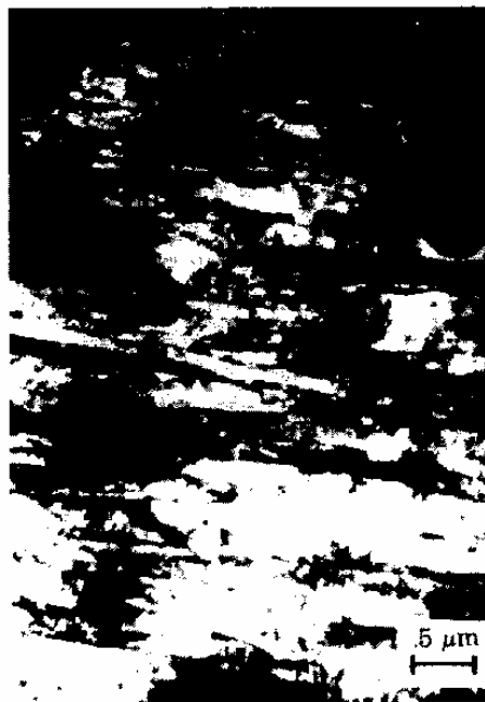
FIGURA 9.15 Estrutura da martensite em ferritas numa liga Fe-0,2% C. (Note-se o alinhamento paralelo das ferritas.) (A. R. Marder e G. Krauss, ASM , 60:651(1967).)
