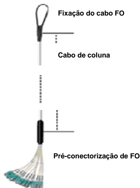
Figura 61 – Cabo de coluna de fibra óptica, pré-conectorizado
