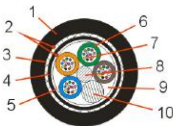
Figura 30 – Cabo de fibras ópticas para conduta
