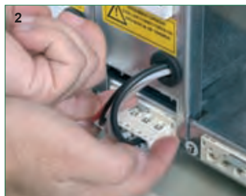
2 Extraer conector rápido
