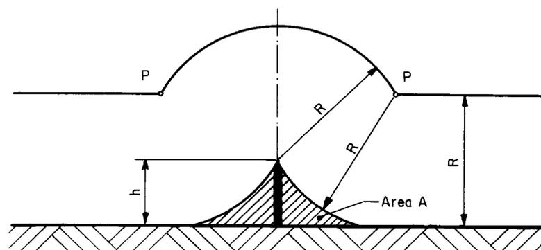
Figura C.2 - Volume de proteção do captor  $h < R$
