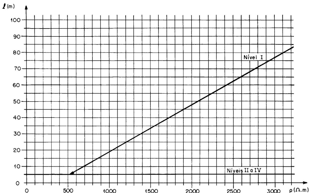
NOTA - Para os níveis II a IV, o comprimento mínimo do eletrodo é independente da resistividade.
