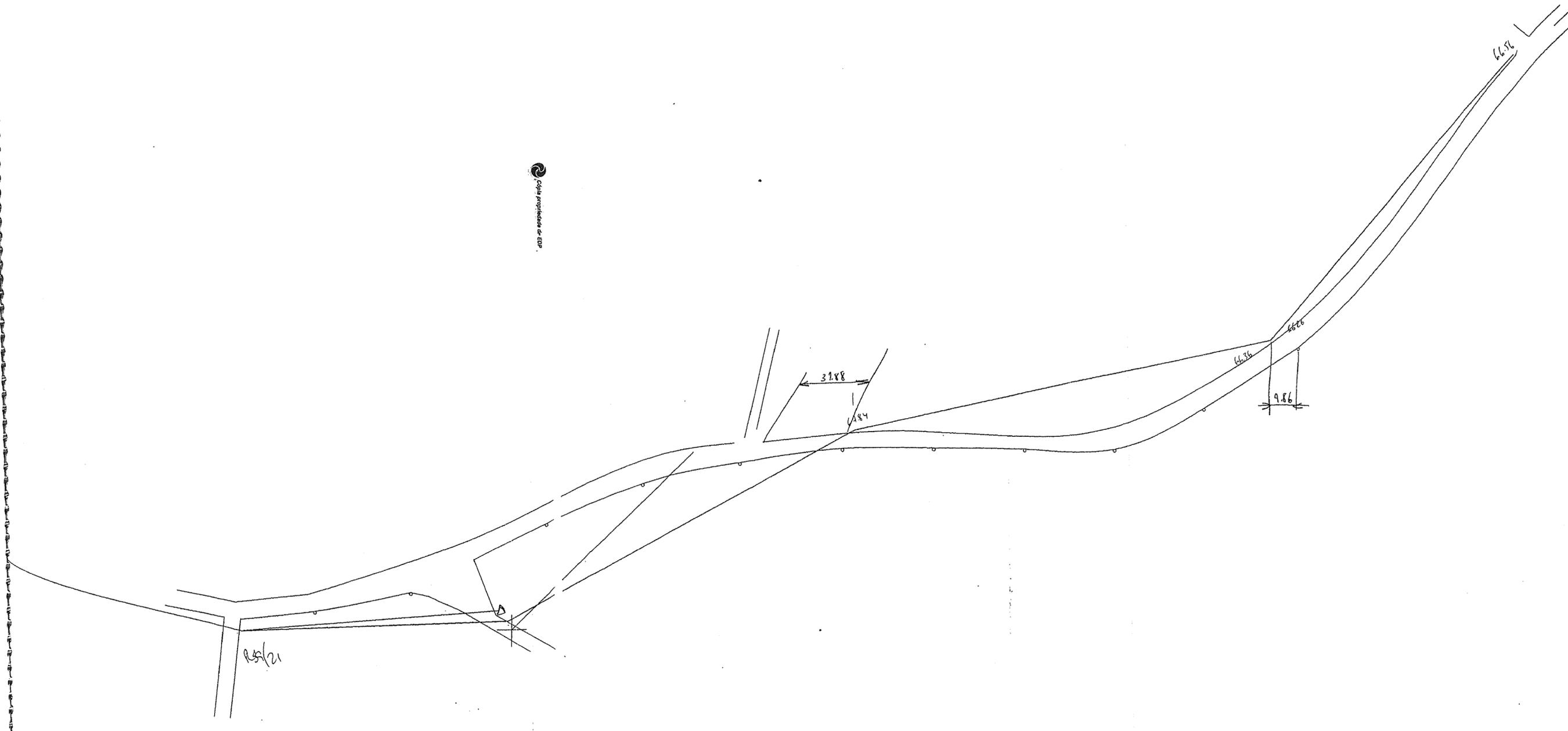
$\phi$  Al-aço 50mm<sup>2</sup>  $T_{máx.} = 6kg/mm^2$      $\phi$  Al-aço 50mm<sup>2</sup>  $T_{máx.} = 7kg/mm^2$
