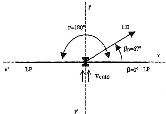
A primeira fase consiste em escariar o apoio, de modo a que o seu eixo dos  $yy$  passe na bissetriz do ângulo existente da linha principal. Sabendo o ângulo  $\alpha$  que a linha faz naquele apoio, os ângulos  $\beta$  e  $\theta$  determinam-se da seguinte forma:
