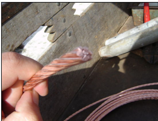
Fig. 29 - Marinhas (Esposende), Condutor: cabo de cobre nu multifilar de 35 mm 2
